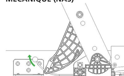
En cas de panne de courant ou d'une panne inattendue, la fonction abaissement d'urgence mécanique permet d'abaisser à la main complètement la zone dorsale et/ou la zone pieds par actionnement du mécanisme à traction.
